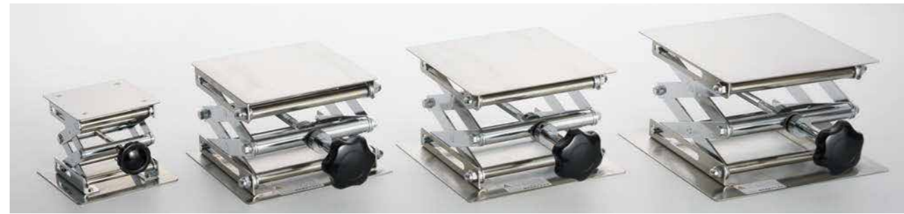
SS10-12 SS16-18 SS18-20 SS20-23 ●SS16-18・18-20・20-23, SUS16-18・18-20・20-23にはスラストベアリングが取り付けられています。(SS10-12型を除く) ●一本の回転軸で天板を昇降させるラボジャッキは、水平に保つことが難しいため、天板には均等に分散するような荷重のかけ方をしてお使い下さい。
