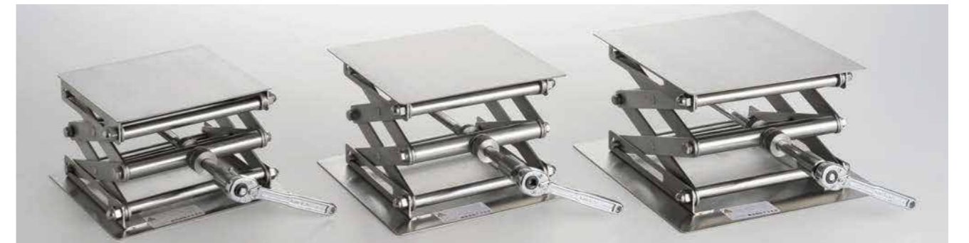
RSS16-18 RSUS16-18 RSS18-20 RSUS18-20 RSS20-23 RSUS20-23 ●上昇時に軽力で上がるようにスラストベアリングを取り付けてあります。 ※RSS16-18~20-23型のスラストベアリングは樹脂製保持器を採用しています。 ●一本の回転軸で天板を昇降させるラボジャッキは、水平に保つことが難しいため、天板には均等に分散するような荷重のかけ方をしてお使い下さい。
